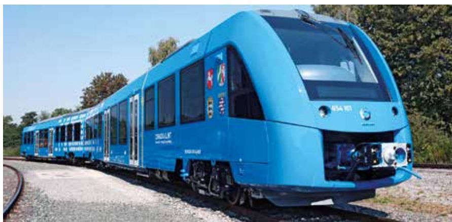
Coradia iLint, il treno a idrogeno testato in Germania
